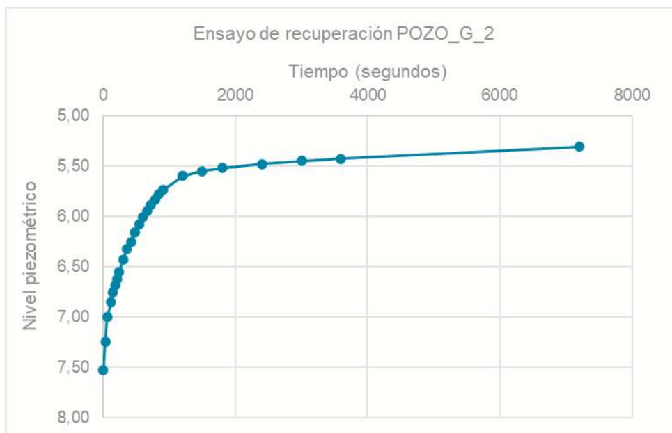
Figura 17. Representación gráfica del ensayo de recuperación en el POZO_G_2.
