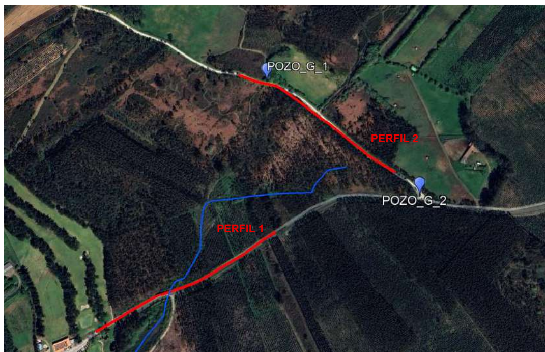
Figura 21. Perfiles geoelectricos 1 y 2 en Larín (Arteixo, A Coruña).
